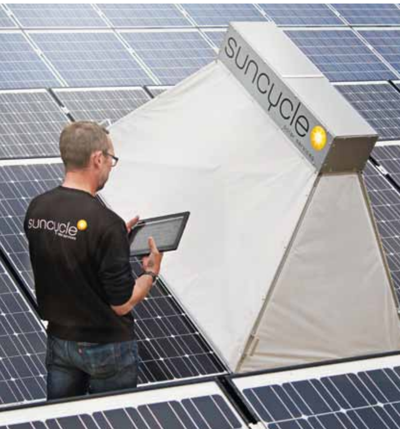
Per Elektrolumineszenz direkt in der Anlage detektiert Suncycle PID.
