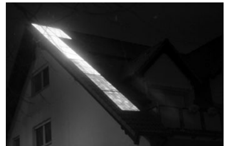
Dunkle Zellen an den Modulrändern und am Ende des Strings sind ein deutliches Zeichen für PID.
